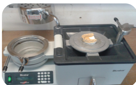
Fig. 6 : L'étape de thermoformage de la plaque Fig. 6: Thermoforming step
