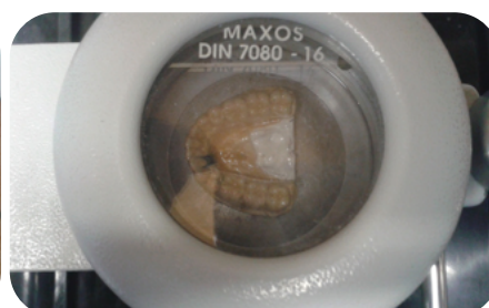
Fig. 6 : L'étape de thermoformage de la plaque Fig. 6: Thermoforming step
