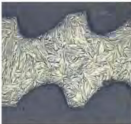
Figure 4 : Lime ProFile utilisée 7 fois (PS) .Etat cristalllographique en coupe transversale
