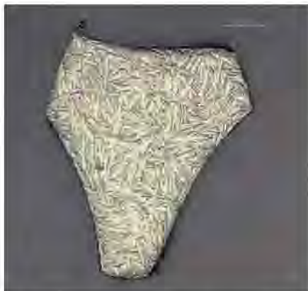
Figure 3 : Lime ProFile neuve (PS) . Etat cristalllographique en coupe transversale
