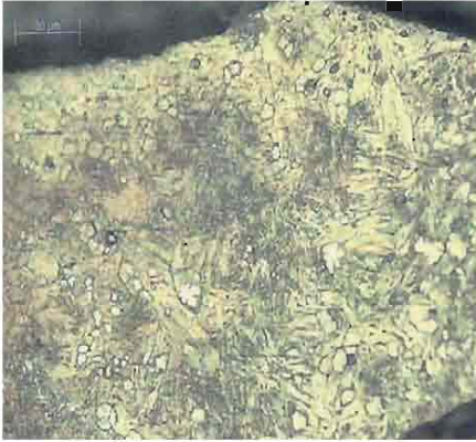
Figure 5 : Lime ProTaper (XS) utilisée 7 fois. Etat cristallographique en coupe transversale
