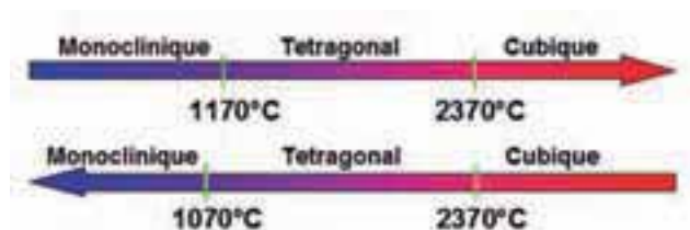
Fig. 1 : Transformations allotropiques des cristaux de ZrO_2 au cours du réchauffement et du refroidissement
